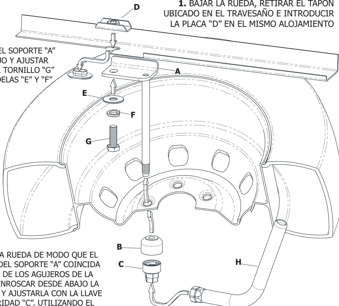
**3.** SUBIR LA RUEDA DE MODO QUE EL TORNILLO DEL SOPORTE "A" COINCIDA CON UNO DE LOS AGUJEROS DE LA LLANTA Y ENROSCAR DESDE ABAJO LA TUERCA "B" Y AJUSTARLA CON LA LLAVE DE SEGURIDAD "C", UTILIZANDO EL TUBO LLAVE "H"
